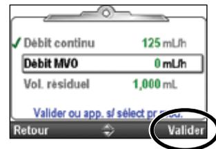
Si le paramètre mis en surbrillance est incorrect, appuyez sur **select** pour le modifier. Appuyez sur **▲** ou sur **▼** pour modifier le paramètre, puis appuyez sur **Enreg.** ou sur **Confirmer**.
