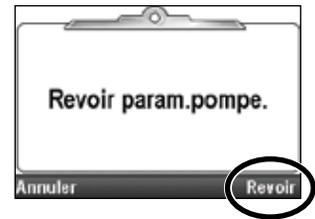
9. Appuyez sur **▲** ou sur **▼** pour faire défiler et revoir tous les paramètres. Si le paramètre mis en surbrillance est correct, appuyez sur **Valider**. Une coche verte apparaît en regard du paramètre.
