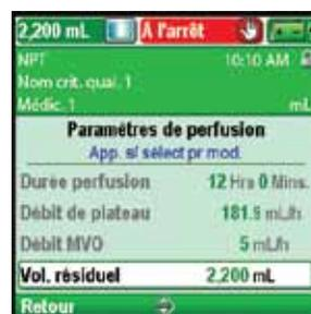
Si la perfusion MVO est prévue à la fin de la perfusion, le volume résiduel doit être supérieur au volume à perfuser afin de compenser le liquide utilisé durant la purge de sorte que la perfusion MVO automatique puisse avoir lieu. La perfusion MVO continue jusqu'à ce que le volume résiduel atteigne 0 mL ou jusqu'à l'arrêt de la pompe. Si le volume résiduel est identique au volume de perfusion, la perfusion MVO n'aura pas lieu à la fin de la perfusion.
