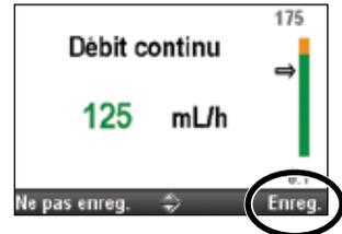
**Remarque :** si la nouvelle valeur est supérieure à la limite standard maximum ou inférieure à la limite standard minimum, elle apparaît en orange à l'écran. Pour sélectionner une valeur supérieure à la limite standard maximum ou inférieure à la limite standard minimum, sélectionnez **Confirmer**, puis sélectionnez **Oui**.
