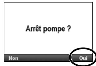
3. La pompe cesse de fonctionner. Le message « En marche » dans le carré vert de la barre d'état est remplacé par le message « À l'arrêt » dans le carré rouge et « Arrêt pompe... » apparaît brièvement.
